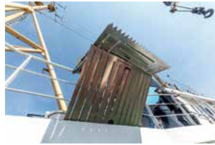
Het uitvoerig geteste Nederlandse Seaboc systeem maakt opklimmen onmogelijk.
