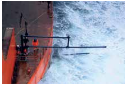
De P-trap bestaat al langer maar is nu aangepast zodat het systeem ook op vissersschepen toepasbaar is terwijl zij vissen.
